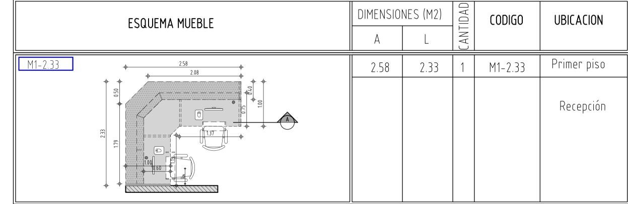
TODOS LOS HERRAJES DE LOS MUEBLES DEBEN SER EN BISAGRAS DE PARCHE Y SEMIPARCHE NEUMÁTICAS CIERRE LENTO, CORREDERAS METÁLICAS FULL EXTENSIÓN TIPO PESADO Y TRAMPA PARA CAJONERAS METÁLICA MARCA FUERTE, ASI COMO LOS SOPORTES DE ENTREPAÑOS DEBEN SER EN ACERO
